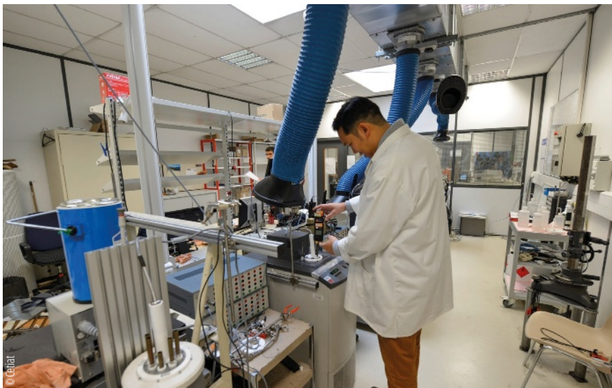
Introduction d'un thermomètre dans un bain d'étalonnage.
