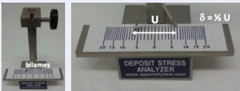
FIGURE 3 : Analyseur pour déterminer l'écartement U entre les bilames.
