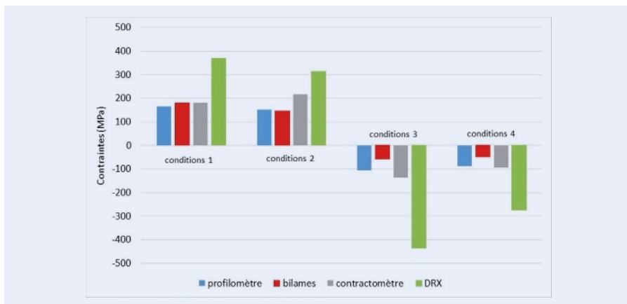
FIGURE 9 : Comparaison des contraintes résiduelles des dépôts de Ni sous 4 conditions opératoires et déterminées par quatre méthodes : profilomètre, bilames, contractomètre et DRX.
